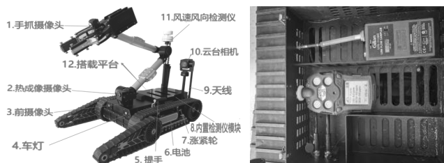
图 1 采样检测机器人结构图及搭载平台内部
